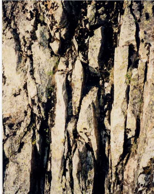
Abb. 1 Typische Ausbildung des Granits von Velay, mit Kluftsystem.
