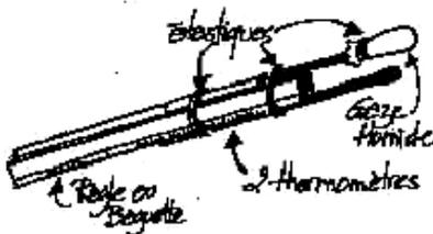
Plus l'écart entre les températures est grand (température sans la gaze, ambiante ≠ température avec la gaze, humide), moins il y a d'humidité dans l'air où s'effectue la mesure. En revanche, plus l'écart est faible, plus l'humidité est grande et proche de l'humidité de la gaze.
